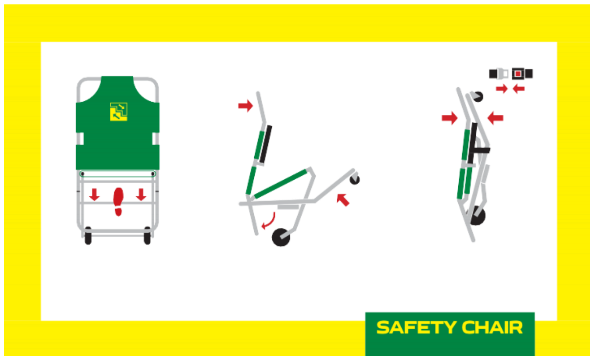
Rys. Prezentacja kolejnych etapów składania krzesła ewakuacyjnego EV-2000.
